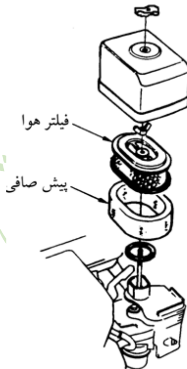
شکل ۲۰: محل قرار گیری فیلتر هوا و پیش صافی
